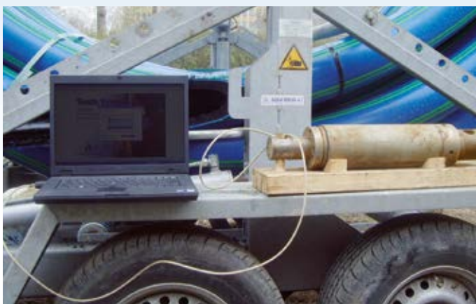
Bildet viser trekkmålingsregistrerin av utført utblokking.
