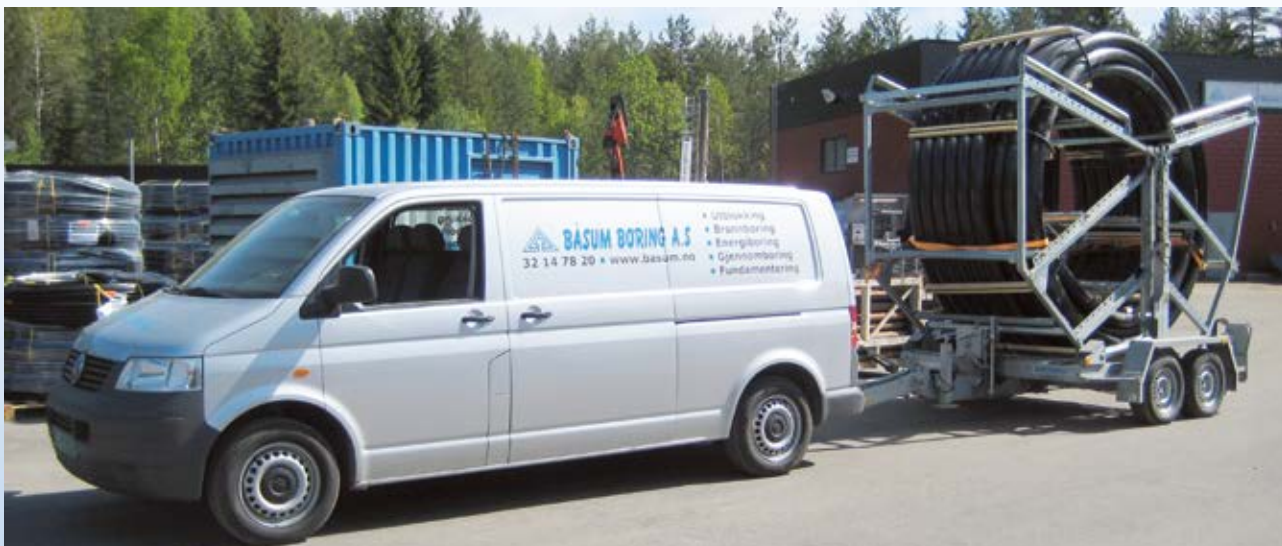
200 meter med Ø140mm PE 100 SDR 11.
